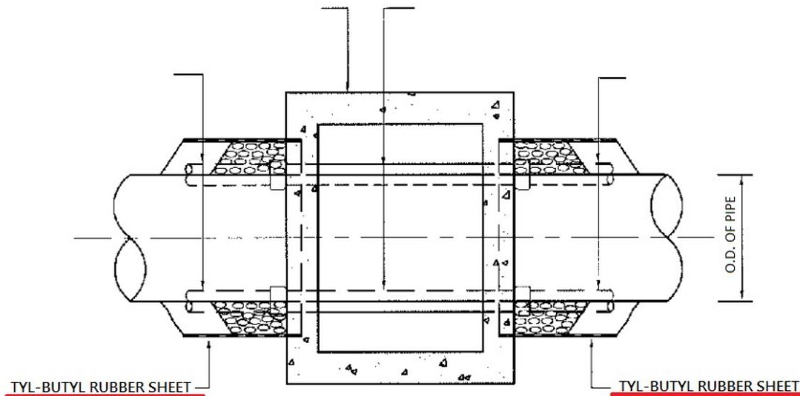
TYPICAL DETAILS OF LEAKAGE COLLECTION SYSTEM
